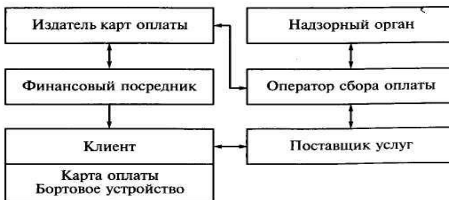
Рис. 5.8. Схема системы электронной оплаты EFC
