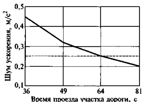
Рис. 2.15. Изменение шума ускорения при увеличении времени проезда участка дороги за счет простоя на перекрестке
