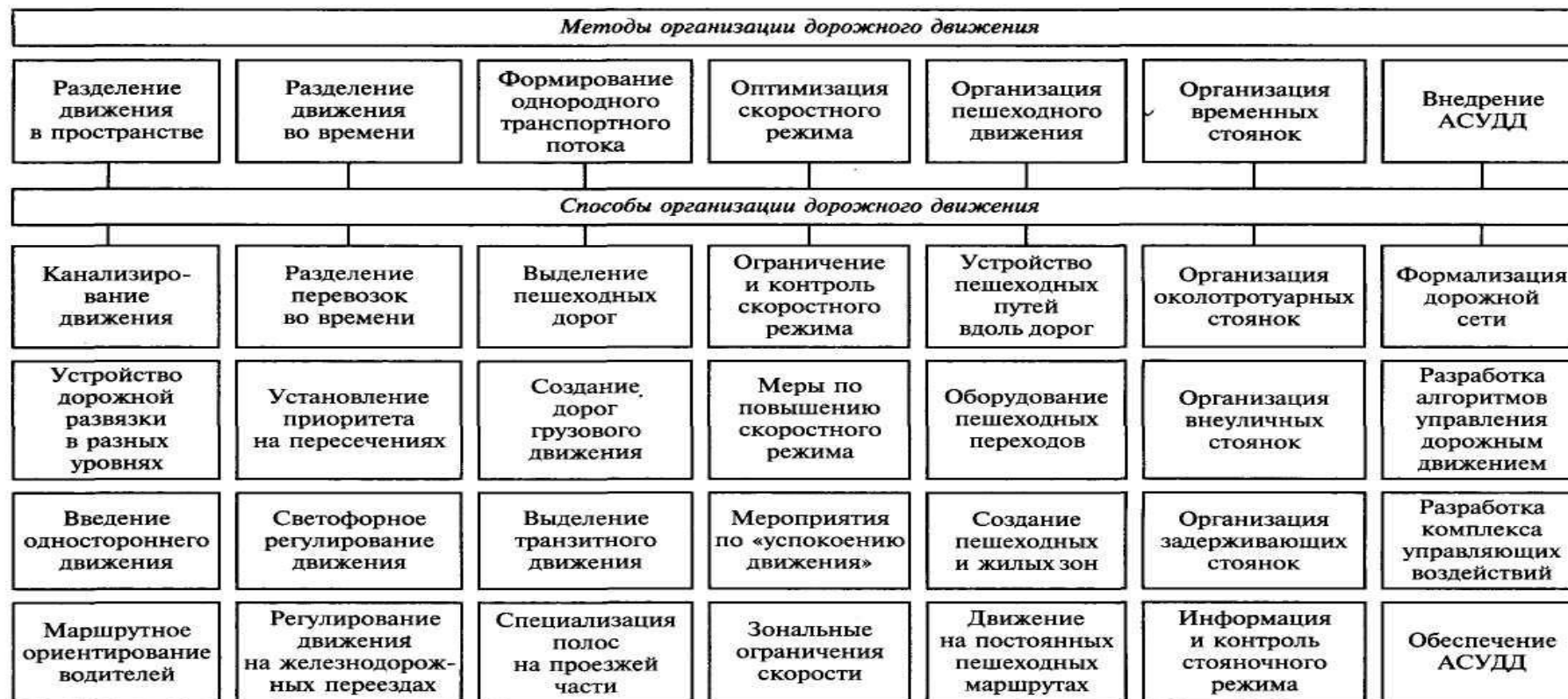
Рис. 2.5. Основные методы и способы организации дорожного движения (АСУД – автоматизированная система управления дорожным движением)
