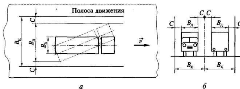
Рис. 6.4. Коридор движения на однополосной (а) и двухполосной (б) дороге:
