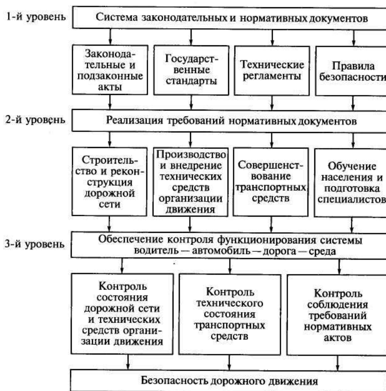
Рис. 1.8. Схема управления системой водитель – автомобиль – дорога - среда
