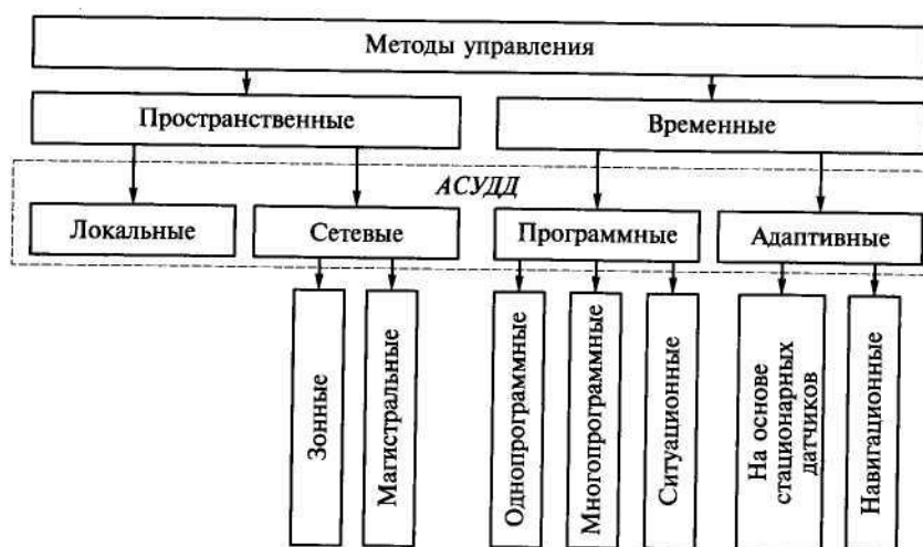
Рис. 5.3. Классификация АСУДД (автоматизированной системы управления дорожным движением)
