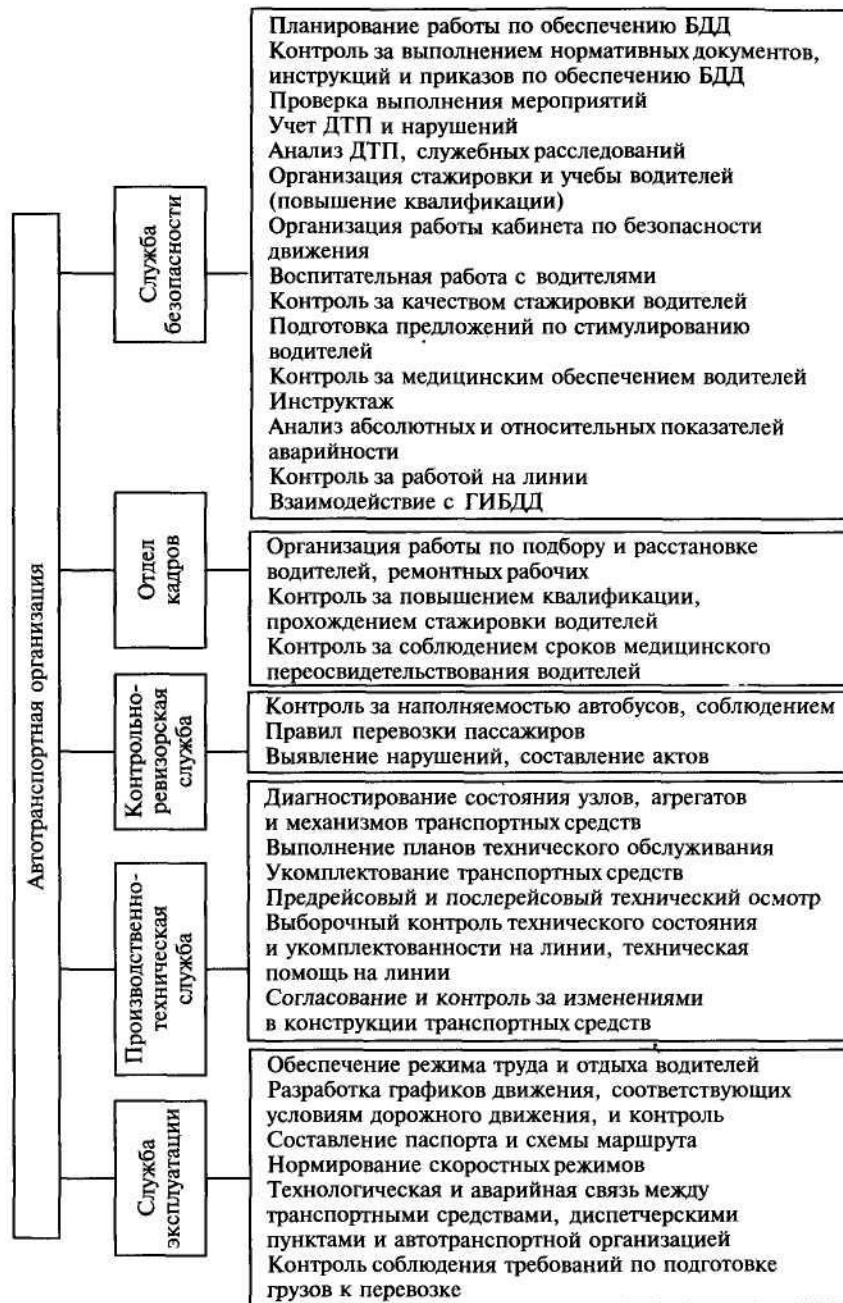
Рис. 4.5. Задачи служб автотранспортной организации по обеспечению безопасности дорожного движения (БДД)
