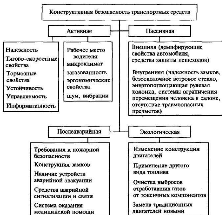
Рис. 6.1. Классификация конструктивной безопасности транспортных средств
