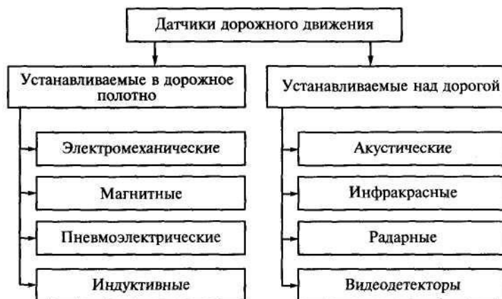
Рис. 5.5. Классификация наиболее распространенных датчиков дорожного движения
